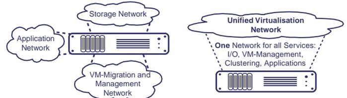
Connectivity-Anforderungen eines Hypervisor-Nodes in konventionellen Virtualisierungsumgebung (links) im Vergleich mit denen bei Verwendung von UVE (rechts).
